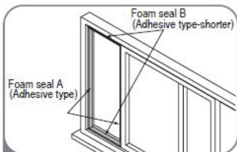
1 Couper les bandes A et B en mousse adhésive aux longueurs appropriées et les fixer sur le cadre et le cadre de la fenêtre comme illustré.
