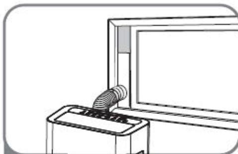
5 Insérer l'adaptateur de curseur de fenêtre dans le trou du curseur de la fenêtre.
