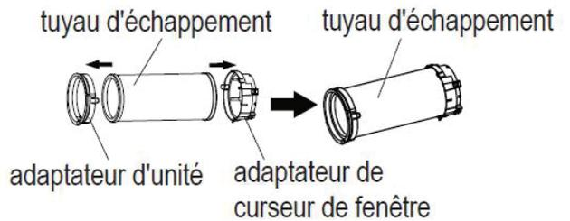
Insérez l'adaptateur dans la rainure inférieure de la sortie d'air de l'appareil. Assurez-vous que le crochet de l'adaptateur est aligné avec le siège trou de la sortie d'air et faites glisser vers le bas dans le sens de la flèche sur l'appareil.
