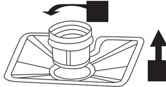
**Étape 1.** Faites tourner le filtre fin dans le sens contraire des aiguilles d'une montre.
