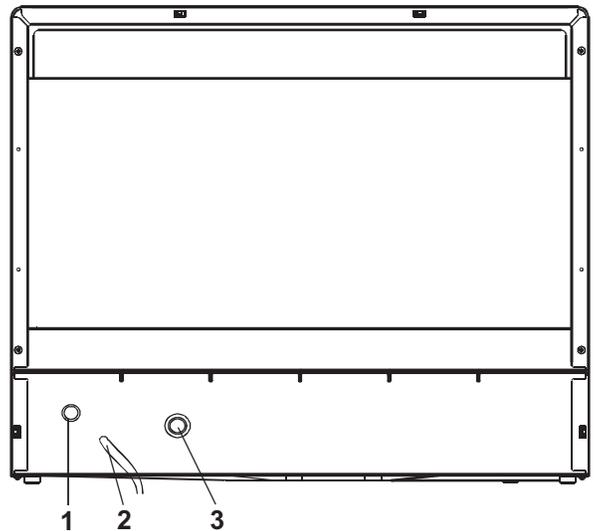
Votre lave-vaisselle est doté d'un raccord à branchement rapide (comprend l'admission et le tuyau de drainage). L'adaptateur de robinet doit être installé sur le robinet avant de pouvoir raccorder le lave-vaisselle. Cet adaptateur est inclus dans votre lave-vaisselle. L'adaptateur de robinet est compatible avec les robinets, que les raccords de robinet soient mâles (filetés à l'extérieur) ou femelles (filetés à l'intérieur).
