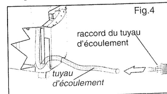
Remarque: Il faut se rappeler de renverser les procédé ci-dessus lors du déplacement de l'appareil à une autre location où l'option d'écoulement continu (drainage direct) est impossible. Défaut de suivre ces procédés occasionnera une inondation.
