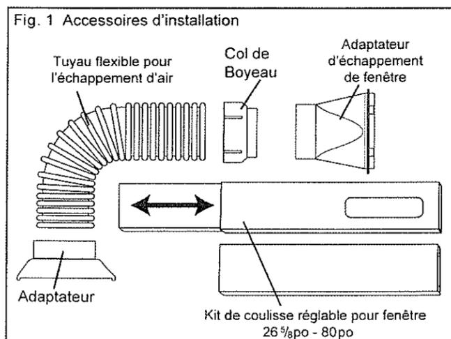
**REMARQUE SPÉCIALE :** Le kit d'échappement de fenêtre doit être installé en tout temps quand l'unité fonctionne en mode de CLIMATISATION.
