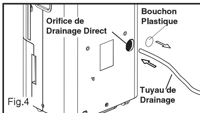
3. Enfoncer fermement sur le raccord, jusqu'à la position de butée. (Fig. 5) Note : la friction assure la rétention du tuyau au niveau de cette connexion; veiller à ce que le tuyau soit complètement enfoncé sur le raccord de drainage.
