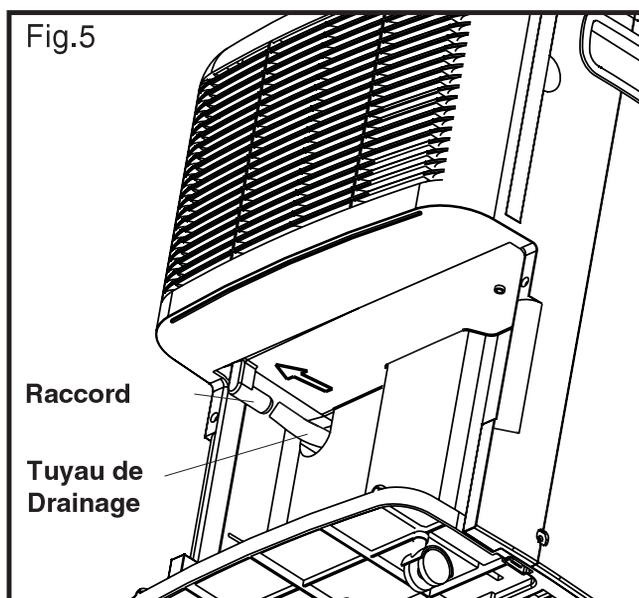
4. Réinstaller le réceptacle à eau; vérifier que le témoin « réceptacle à eau plein » s'éteint. Si le témoin reste illuminé, c'est parce que le réceptacle à eau n'a pas été correctement installé. Même lorsque la fonction de drainage direct est utilisée, le réceptacle à eau doit être correctement installé dans la caisse de l'appareil.
